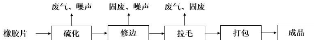
图 5-1 橡胶鞋底工艺流程及产污环节图
